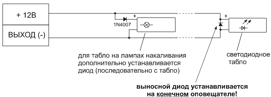
Рис. 6.1. Схема подключения нескольких световых табло
