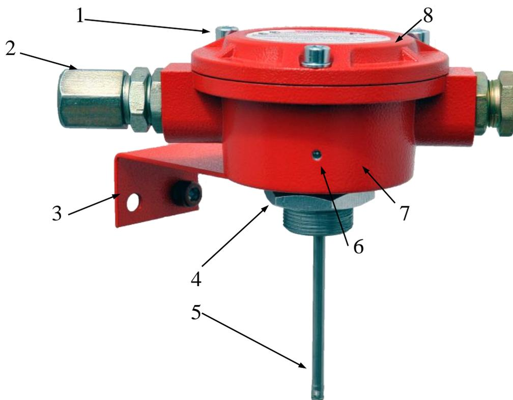
1 – винт М6 с шайбой; 2 – кабельный ввод; 3 – крепежное устройство (К-05); 4 – гайка М30; 5 – чувствительный элемент; 6 – светодиодный индикатор; 7 – корпус извещателя; 8 – крышка извещателя.
