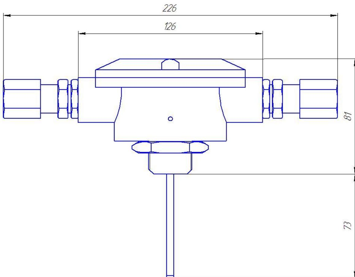
Рис. 1 – Извещатель пожарный тепловой ИП 101-СпектронТ-Р
