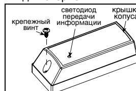
Рис. 4 - Вывинчивание крепежного винта корпуса
