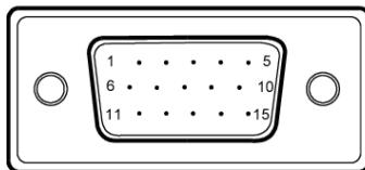
15-контактный сигнальный кабель цветного дисплея
