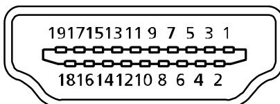
19-контактный сигнальный кабель цветного дисплея\*
