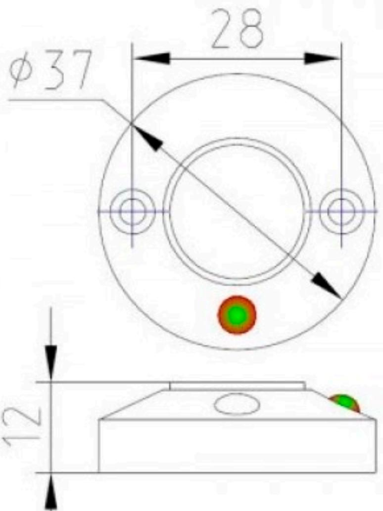
**KC-05-Кнопка выхода со светодиодом.**
