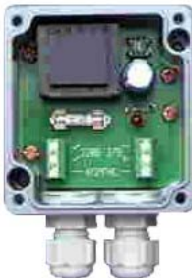
Рис. 8.3. Внешний вид блока питания со снятой крышкой.
