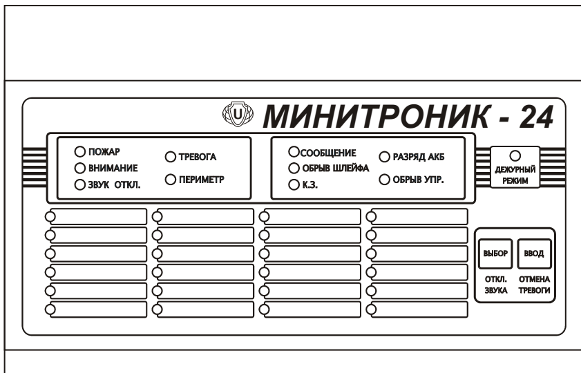
Рис.1. Внешний вид приемно-контрольного охранно-пожарного прибора "Минитроник 24".
