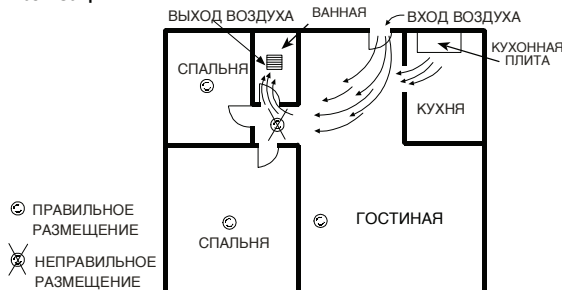
Рис. 10. Рекомендуемые места размещения детекторов для того, чтобы исключить влияние воздушных потоков с частицами продуктов сгорания
