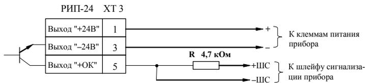
R – оконечный резистор шлейфа, устанавливается в корпусе РИП (входит в состав ЗИП приборов)
