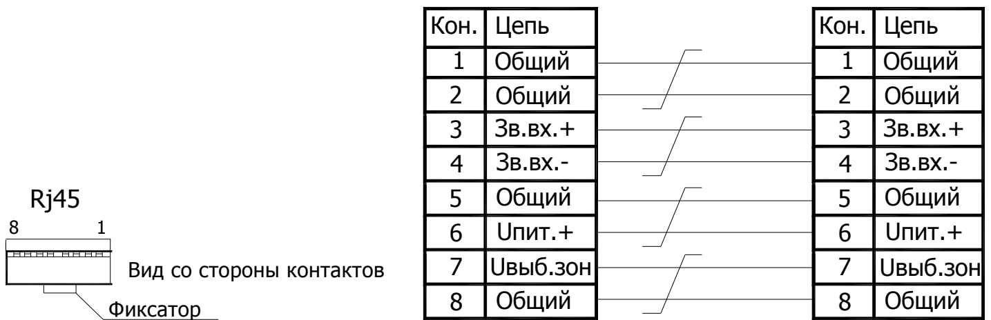
Рис.2 Схема соединения кабеля Нумерация контактов разъема Rj-45 условная.
