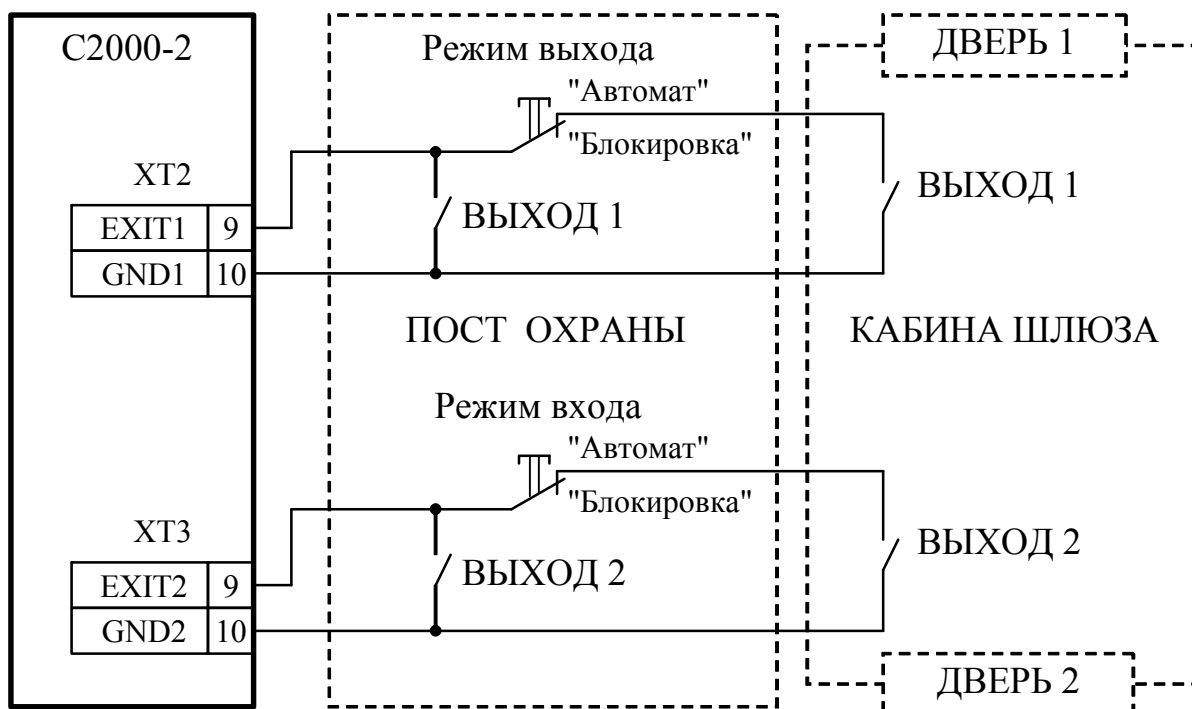
Рисунок 17 Включение переключателей режима доступа шлюза
