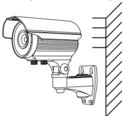
2. Зафиксируйте корпус и крепление камеры. Настройте угол обзора.
