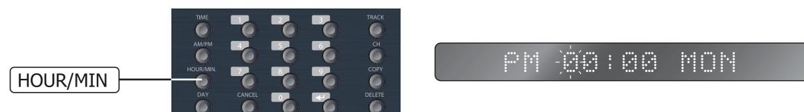
4) Нажмите кнопку HOUR/MIN еще раз. При этом на дисплее начнут мигать цифры, соответствующие минутам. С помощью кнопок 0—9 установите текущее время.
