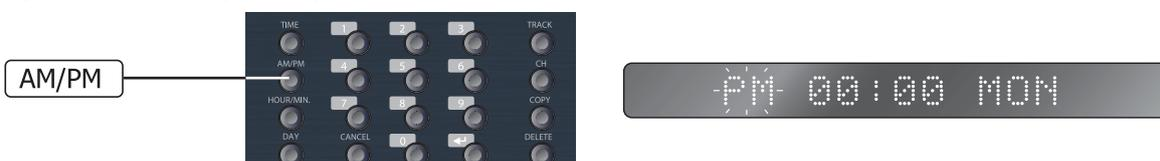
3) Нажмите кнопку HOUR/MIN, при этом на дисплее начнут мигать цифры, соответствующие часам. С помощью кнопок 0—9 установите текущее время.
