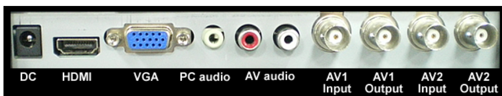
Рис.1. Разъемы монитора LTV-MCL-2212
