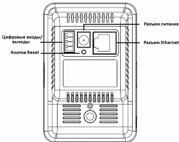
На задней стенке камеры находится разъем для подключения цифровых тревожных входов и выходов, разъем питания и разъем Ethernet.
