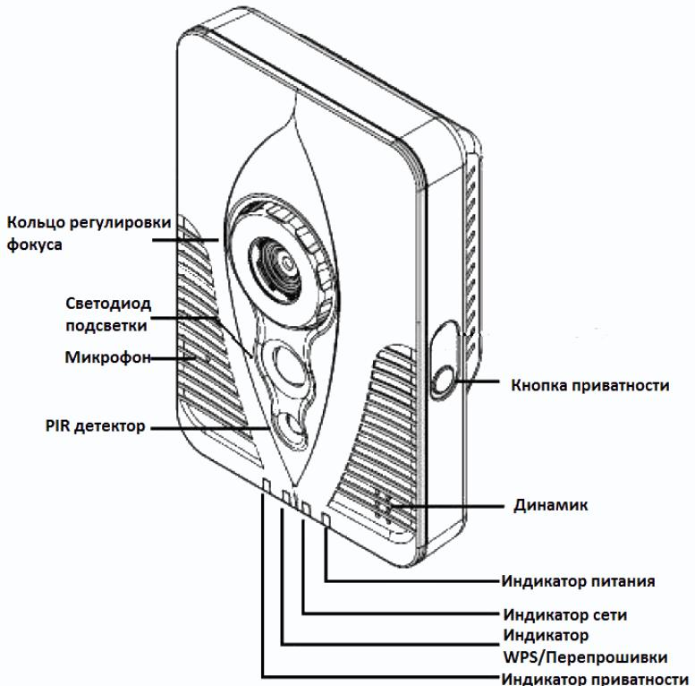
На передней стенке камеры расположено кольцо регулировки фокуса объектива, светодиод подсветки, микрофон, динамик, PIR детектор и индикаторы состояния камеры. Индикаторы показывают наличие питания, наличие подключения к сети, процесс перепрограммации и включения маски приватности.
