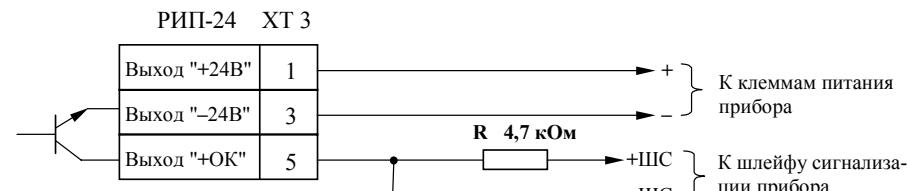
R - оконечный резистор шлейфа, устанавливается в корпусе РИП (входит в состав ЗИП приборов)
